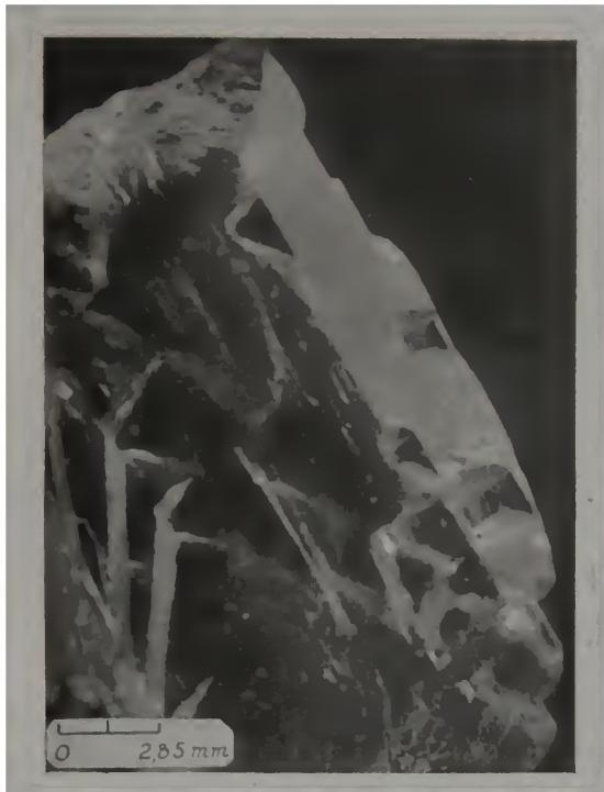
Fotomicrogr. 10 — Canaes de corrosão emergentes das figuras de (010).
