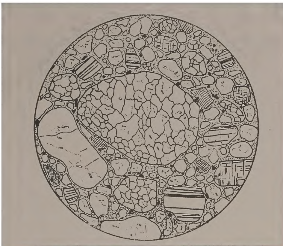
Fig. 17 - Arenito arcossiano, mina do Taboleiro, mun. de Encruzilhada. No centro um grande seixo rolado de quartzito. Veem-se também cristais de plagioclásios, \times 26 .
