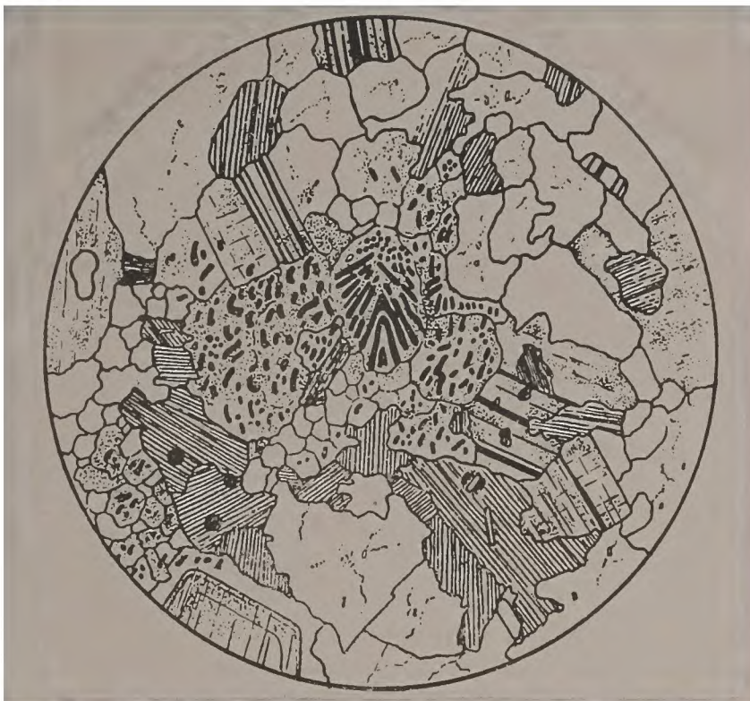
Fig. 14 - Granito, Sanga do Butiá, mun. de Encruzilhada, \times 26 — Fragmentos mostrando típica textura micropegmatítica. Quartzo e biotita com halos pleocróicos.
