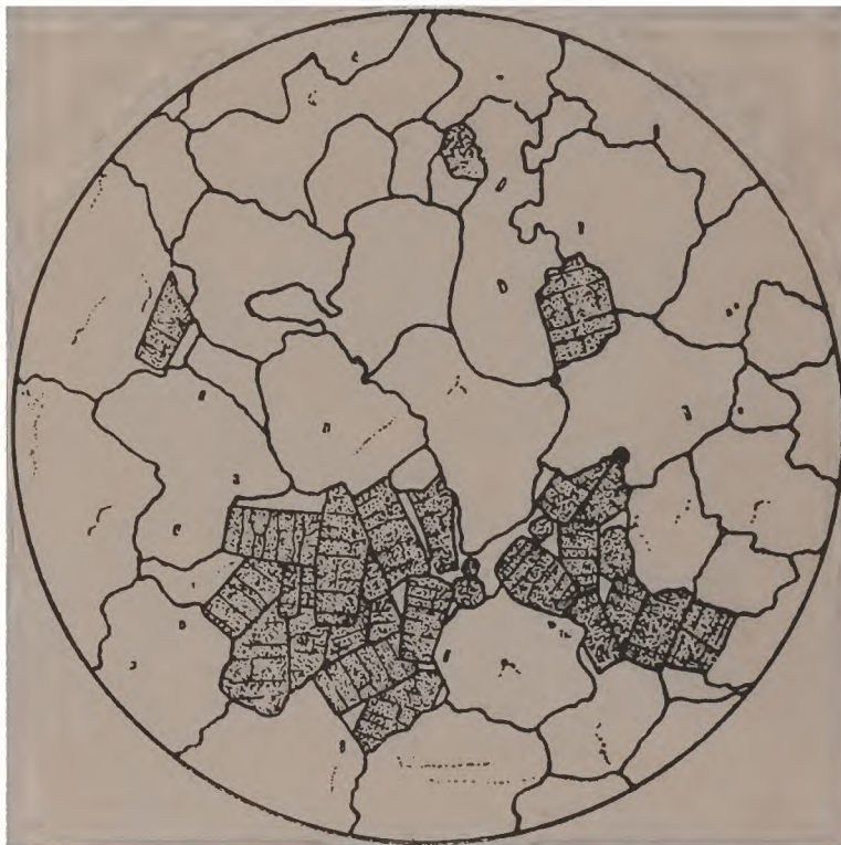
Fig. 23 - Filão de quartzo com nódulos de cristais de turmalina, mina de Santa Bárbara \times 46 .
