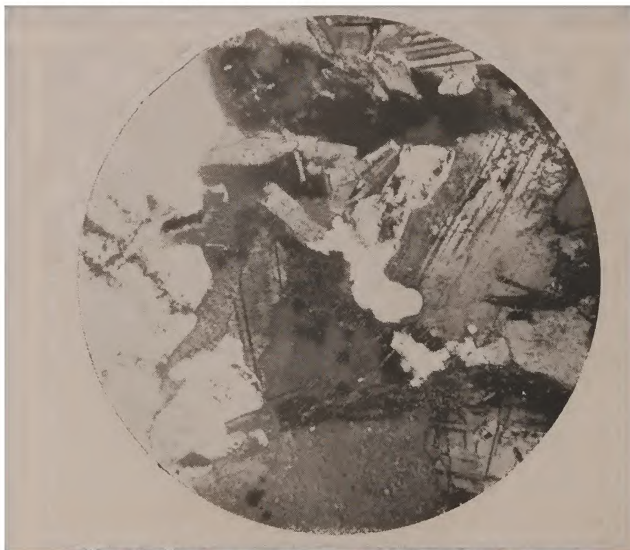
Fig. 13 - Biotita-granito, proximidades da Sanga do Butiá, município de Encruzilhada, N+ \times 35 Biotita mostrando o característico efeito birds' eye maple . Biotita com halos pleocróicos. Oligoclásio, ortoclásio e quartzo.
