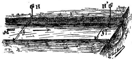
Fig. 32. — Méthode des flotteurs.
