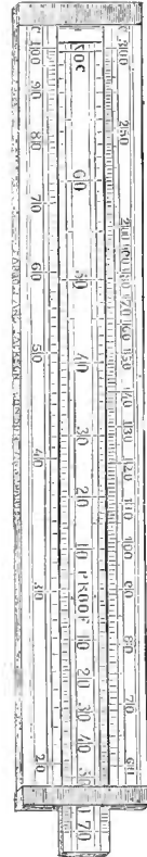
Fig. 214. — Face de la règle à calcul de l'hydromètre de Sikes donnant la quantité d'eau à ajouter pour la réduction d'une force alcoolique à une autre.
