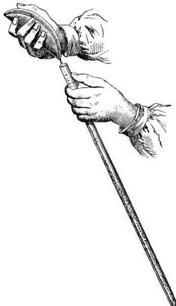
Fig. 561. — Remplissage du tube pour le dosage de l'azote.
