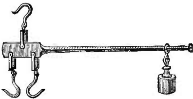
Fig. 572. — Balance romaine construite par M. Paupier.
