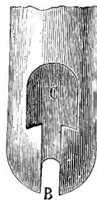
Fig. 133 — Extrémité du gros bout de l'aiguille.
