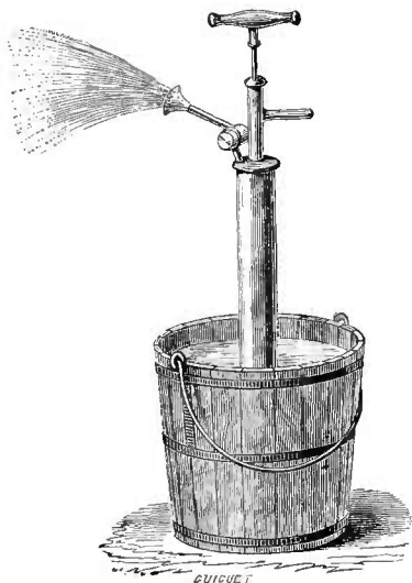
Fig. 606. — Petite pompe à main pour les bassinages.
