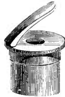
Fig. 151 — Ajutage brise-jets pour petits arrosoirs.
