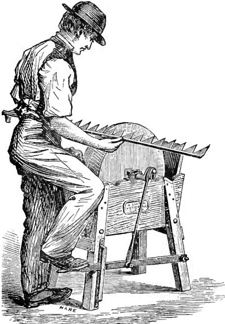
Fig. 137. — Meule Piller pour aiguiser les lames de faucheuses et de moissonneuses.
