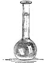
Fig. 165. — Petit ballon jaugé pour les prises d'acide.
