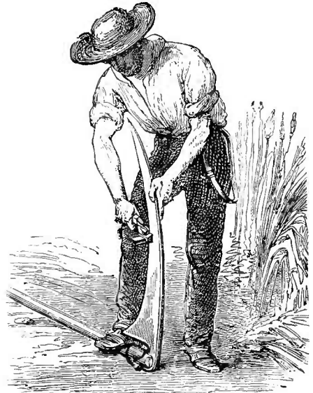
Fig. 135. — Aiguisage d'une lame de faux avec une molette.
