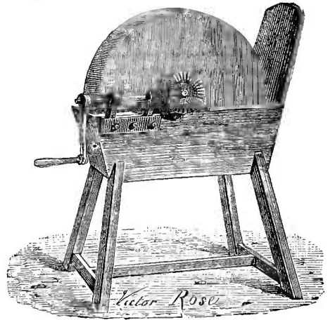
Fig. 138. — Petite meule de Bodin pour aiguiser les outils agricoles.
