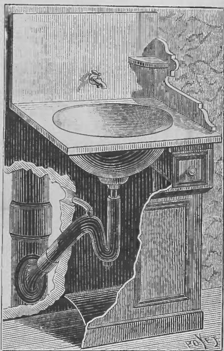
Fig. 43 — Cuvette-toilette munie d'un effet d'eau et d'un siphon obturateur ventilé. (Extrait de *La Nature*.)
