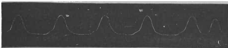
Fig. 72. — Grenouille (cœur entier). — Battements rythmiques normaux — en c, excitation par clôture amenant une secousse de moindre amplitude.
