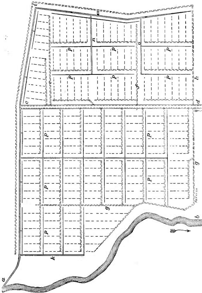
FIG. 359. — MÉTHODE VINCENT; PLAN D'UNE PRAIRIE DRAINÉE ET IRRIGUÉE PAR DÉVERSEMENT.
